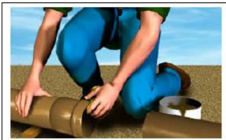
Fig. 01 - Limpeza Primeiramente serão limpas a bolsa e a ponta a serem conectadas.
