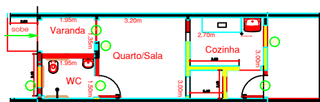
PLANTA BAIXA / CASA TIPO 01 - ÁREA CONSTRUIDA - 26.62 m 2 ESC - 1/50
