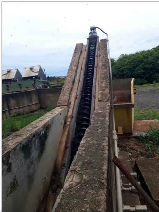
Figura 102 – Eixo de bomba Parafuso..
