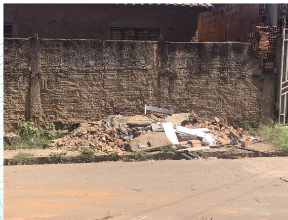
Figura 27 - Disposição irregular de RCC Fonte: Amplar Engenharia
