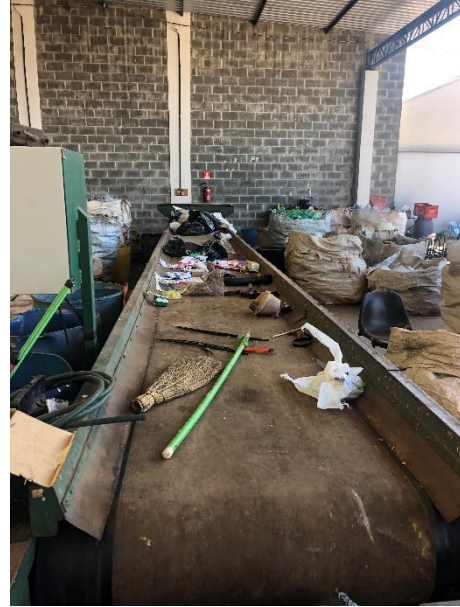
Figura 43 - Esteira da Cooperativa, utilizada para a separação de materiais Fonte: Amplar Engenharia
